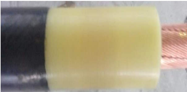
Şekil 5. Ekranı soyularak uzaklaştırılmış YG kablusu
