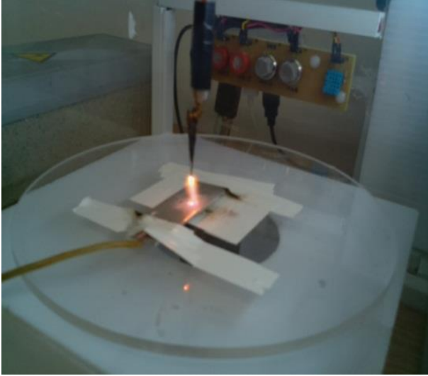
Şekil 1. Deney esnasında çubuk düzlem elektrot arasında oluşan ark
